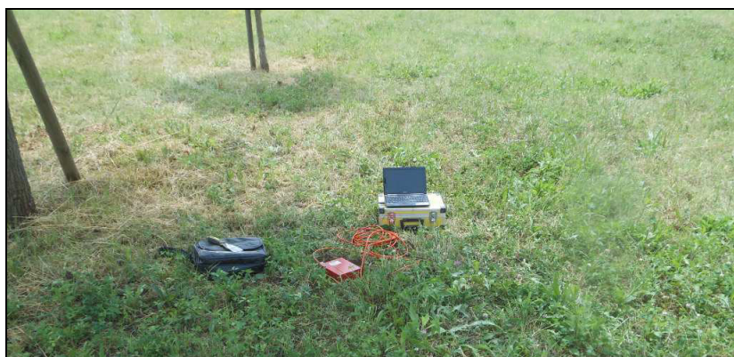
Foto posizionamento indagine sismica HVSR
